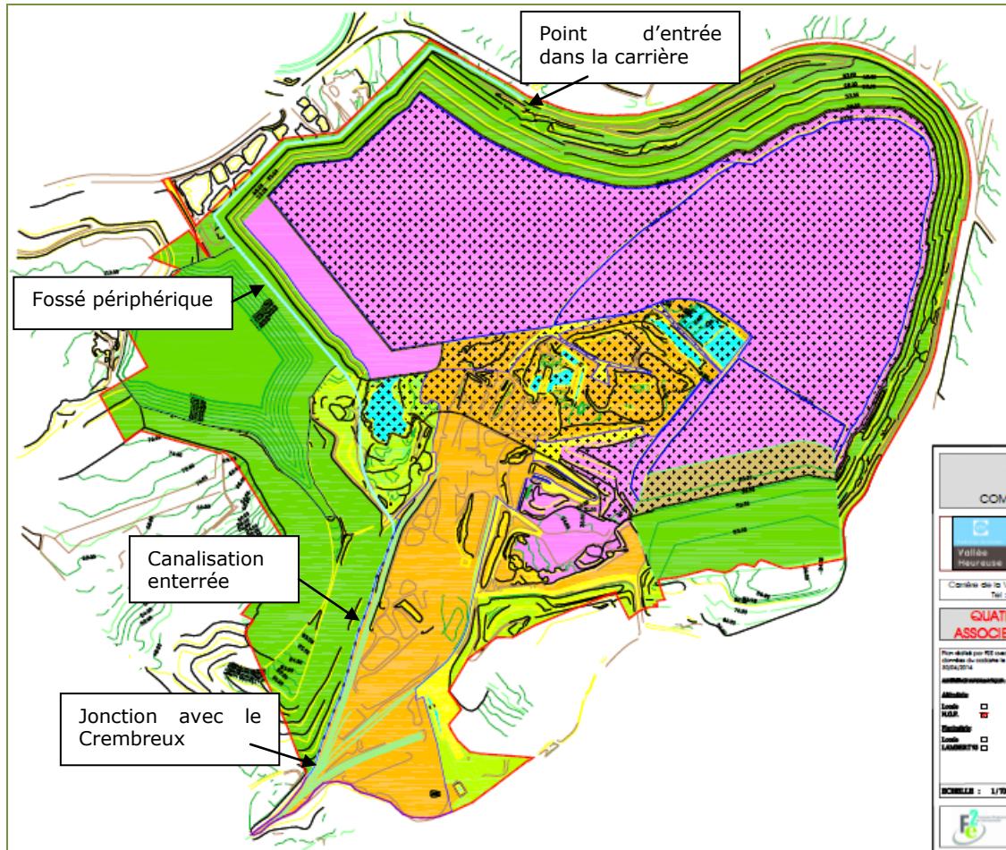
Dispositif de canalisation du ru des Bardes : extrait du plan de la 4 ème phase d'exploitation produit en pièce 9 du dossier
